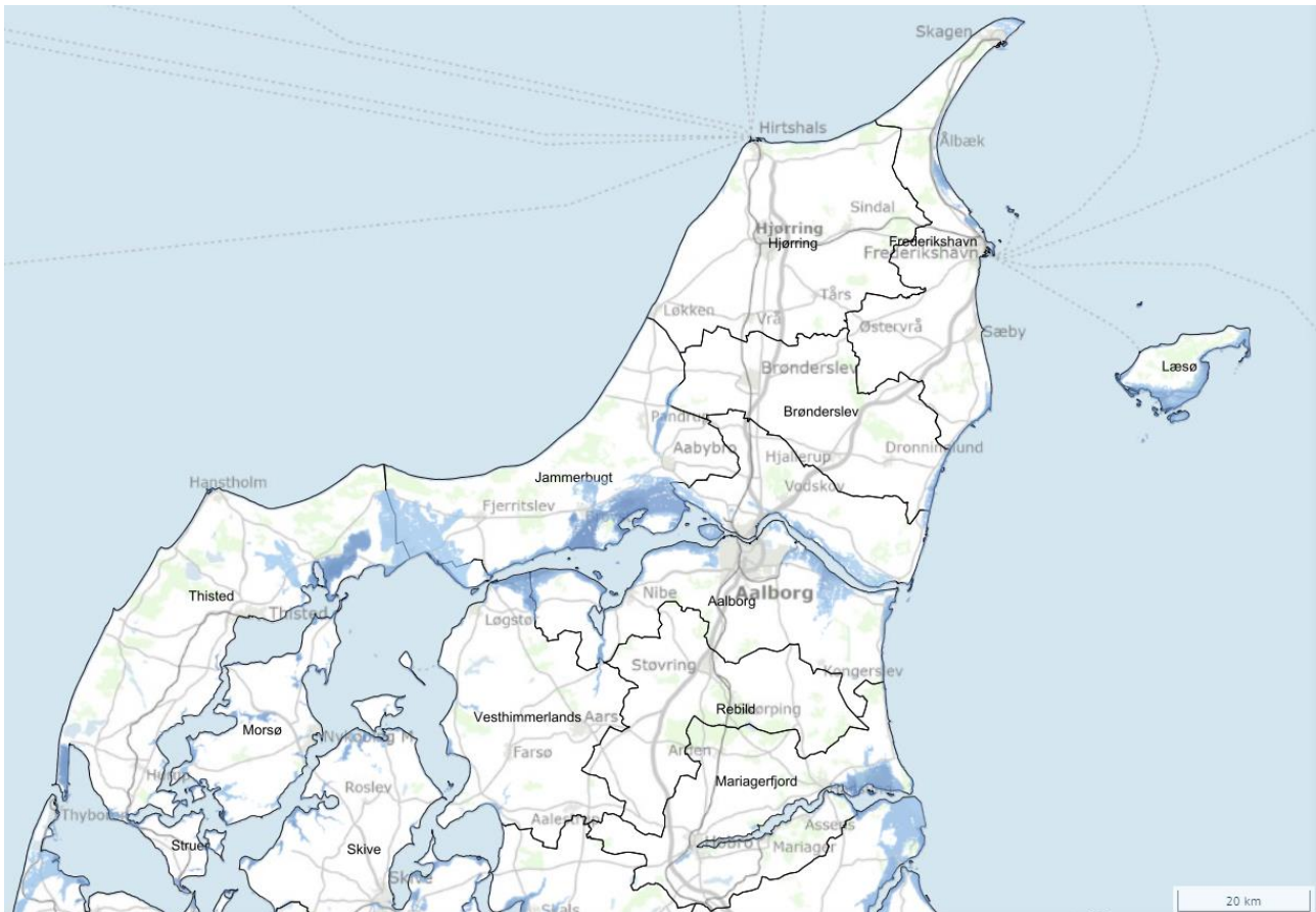
Figur 1 Vandets udbredelse ved en 2,2 meter havvandsstigning. (en stigning på 2,2 meter svare i den vestlige Limfjord til en 50 års stormflodshændelse i år 2071-2100 ved mellem CO 2 -niveau, RCP-scenarie 4,5). Kilde: Klimaatlas DMI , Kamp .
